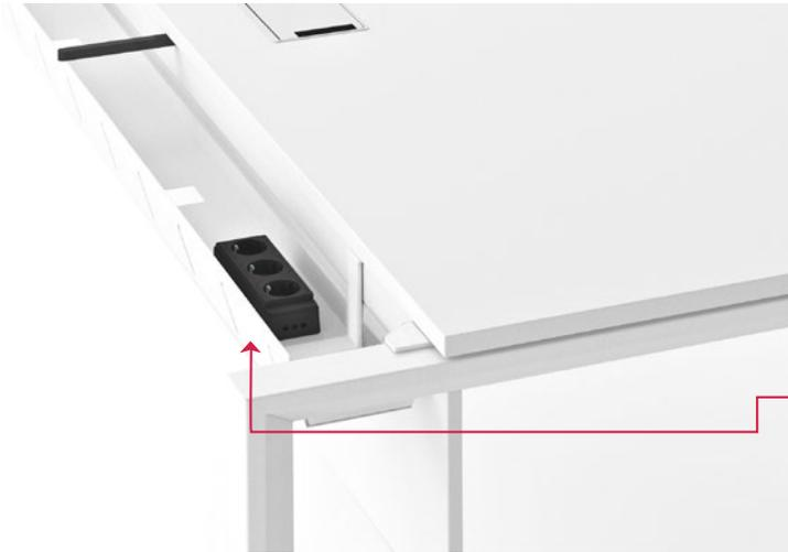
La estructura incorpora un anclaje rápido que permite una perfecta y ágil colocación de la superficie de trabajo en su montaje. Y facilita el desplazamiento del tablero cuando se requiera acceso a la bandeja de electrificación para el manejo, organización y almacenaje del cableado. **(Canal de Electrificación de Acero decapado de 0,7 a 1 mm de espesor)**
