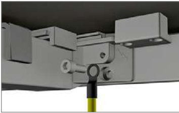
Punto de conexión a toma de tierra (Evita la acumulación de carga electroestática)
