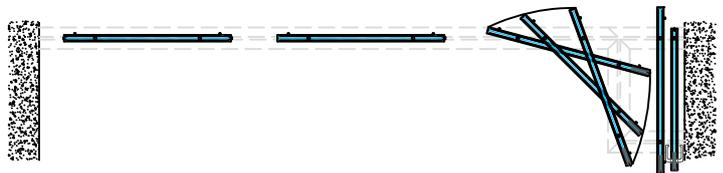
4.- Posición final. El panel abatible puede colocarse a uno u otro extremo del tabique admitiendo el sistema hasta dos paneles abatibles en un mismo tabique.
