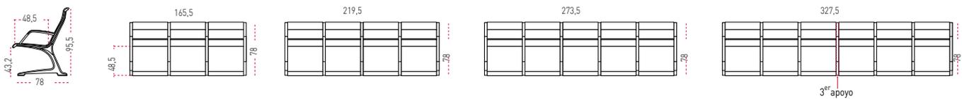
(Las bancadas Passport incorporan un tercer apoyo a partir de configuraciones de 6 puestos)
