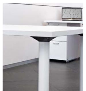
Las patas son de tubo de Ø 60mm, fabricadas en acero laminado en caliente y decapado de 1.5mm de espesor, con recubrimiento epoxi en acabados aluminizado, blanco y negro. El cuerpo superior de la pata está fabricado en inyección de aluminio con recubrimiento epoxi. El montaje se realiza mediante atornillado directo a los insertos metálicos que posee la tapa.
