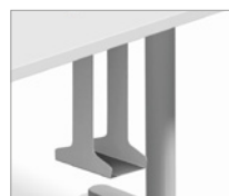
Soporte metálico anclado al larguero
