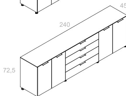
Tablero de fibras MDF alta densidad grueso 22mm. Chapeado/prensado en madera natural 0,6mm de procedencia sostenible con certificado PEFC y FSC.
