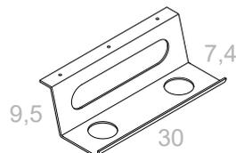
**Bandeja apoyo conexiones V02**
