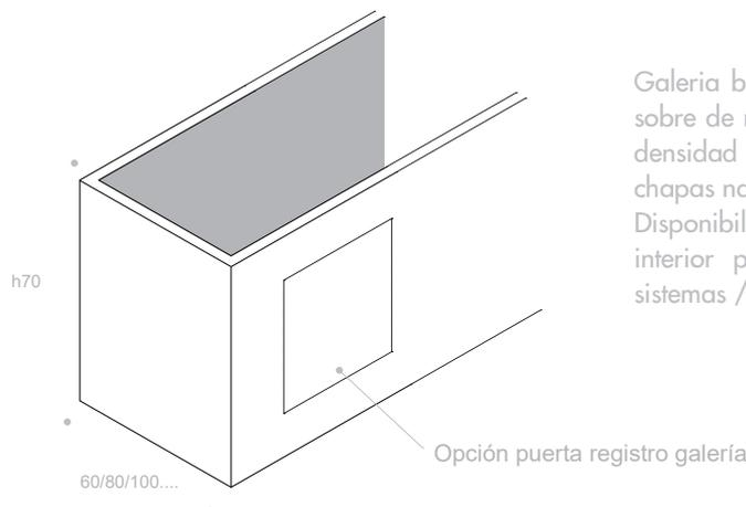
Galería bajo mesa realizada a medida según sobre de mesa. Realizado en tablero MDF alta densidad 25mm espesor. Acabados gamma de chapas naturales o lacados.
